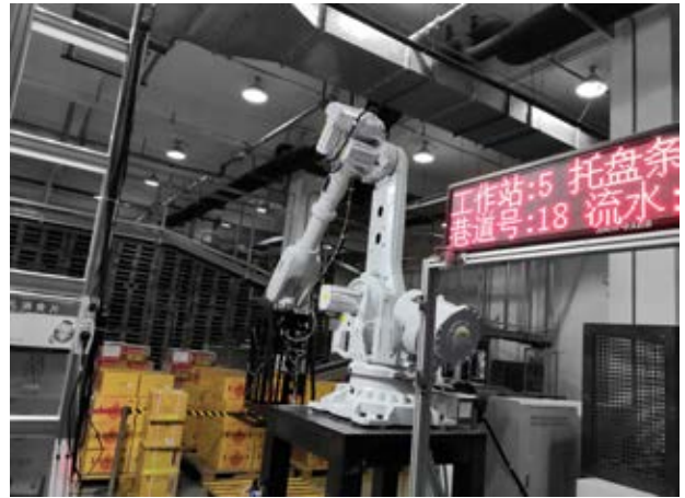
视觉引导机器人拆垛系统
